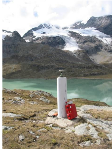
GPS-Messung auf Rückversicherungspfeiler
