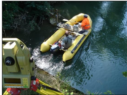
Echolotaufnahmen in Seitenarm der Aare
